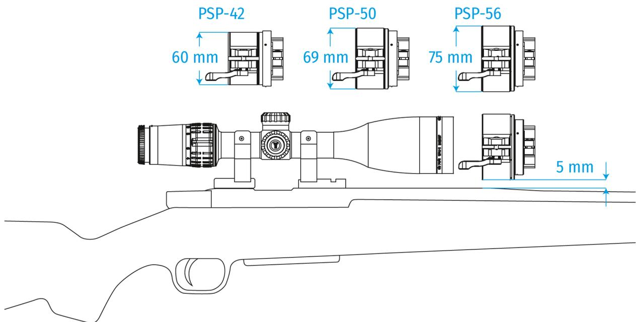
Quando si installa l'adattatore ad anello PSP su un cannocchiale da puntamento, lo spazio tra l'adattatore e il corpo del fucile deve essere di almeno 5 mm.
