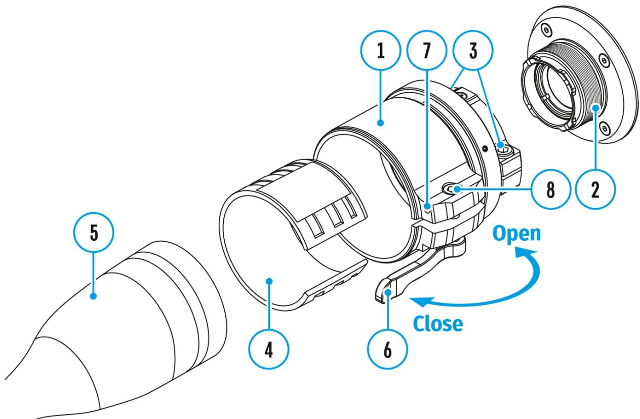
1. Retire la cubierta protectora del ocular del módulo preobjetivo.
